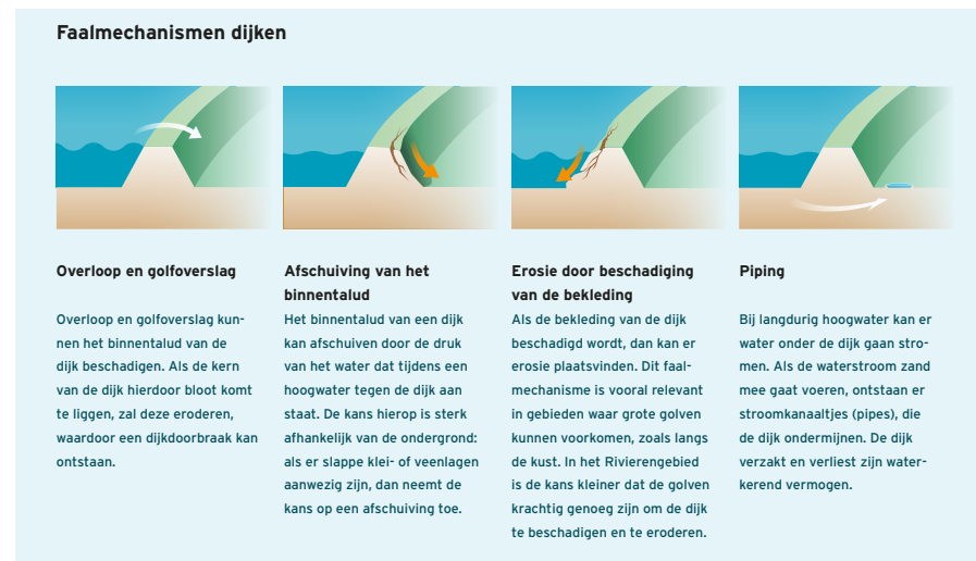
Figuur 4.3 Schematisch beeld van enkele belangrijke faalmechanismen van dijken (bron: VNK)
